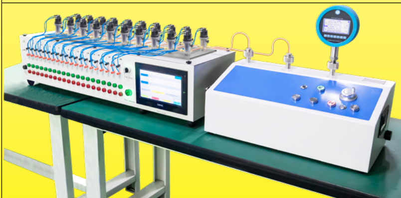
Vérification de l'étalonnage des pressostats
